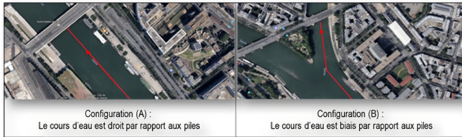
Figure 21 : Représentation de l'orientation possible du cours d'eau par rapport aux piles de l'ouvrage (Source : Cerema)
