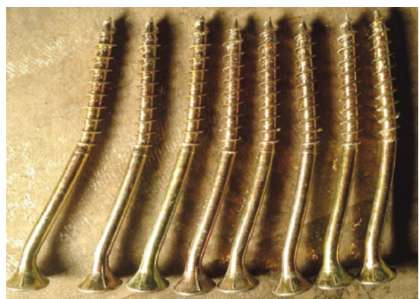
Photo 5 : Déformation avec double rotule plastique dans la tige du tirefond
