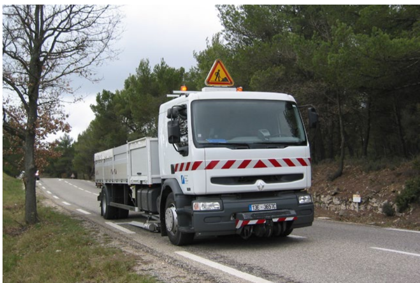
Figure 6 - Mesure de déflexion avec le déflectographe LACROIX en configuration 03 (source: Cerema)
