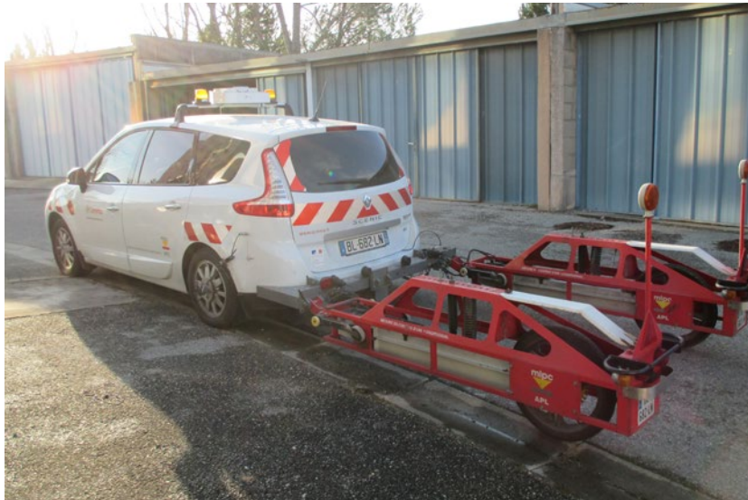
Figure 9 - matériel de référence de mesure de l'uni longitudinal – APL (source: Cerema)
