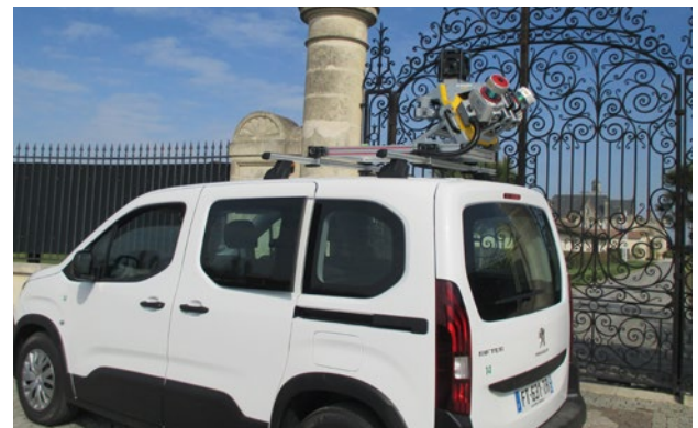
Figure 4 - CereMap3D - Scanner 3D Dynamique d'Environnement du Cerema (source: Cerema)
