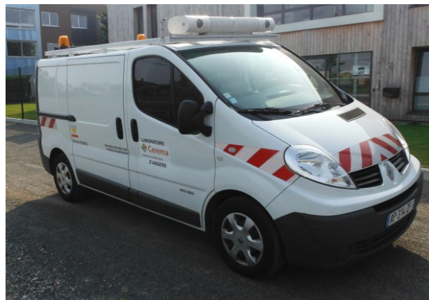
Figure 2 - IRCAN Stéréo - Imagerie Routière par Caméra Numérique (source: https://imagerieroutiere.fr )
