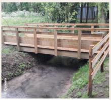
Pont composé d'un tablier (chaussée et équipements de sécurité) posé sur plusieurs appuis (piles et culées).
