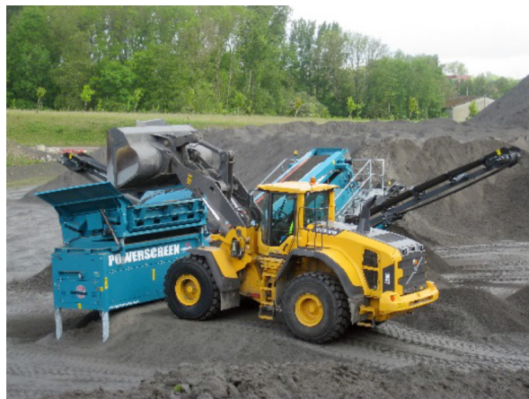
Figure 2 : Illustration de l'extraction de cendres de charbon d'un terril (site de Ansereuilles) (Source : UFCC)
