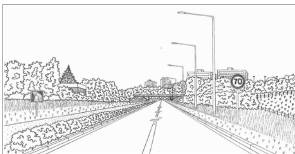
Artère urbaine à une chaussée bidirectionnelle avec une seule voie par sens. Les carrefours sont à niveau.
