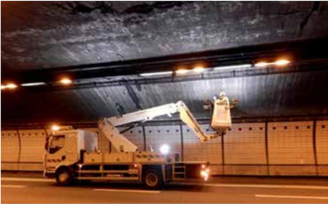
Figure 18a : camion-nacelle du CETU (PEMP de type 2B) équipé de projecteurs
