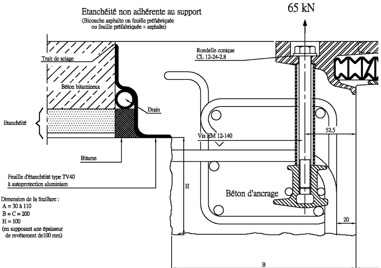
Le ferrailage du béton d'ancrage peut être adapté
