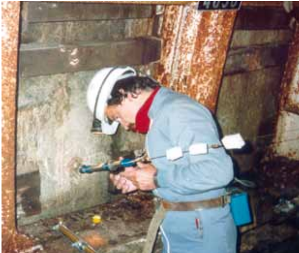
Figure 16 : Mesure de convergence au fil Invar
