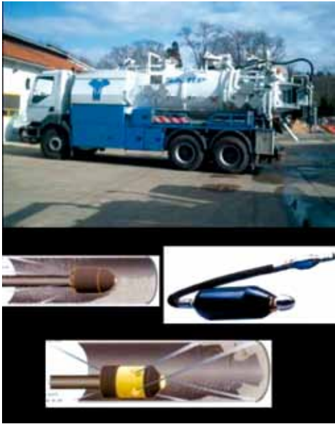
Figure 19 : Matériel pour l'hydrocurage des réseaux de drainage
