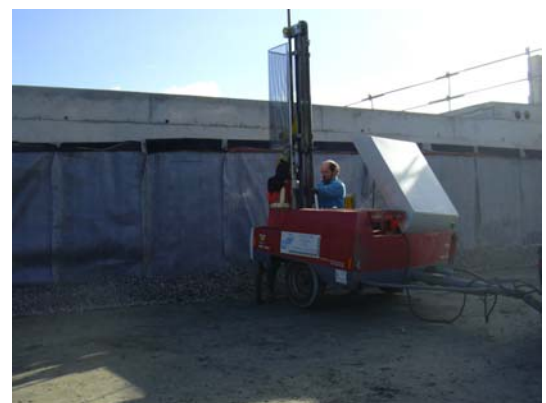
Photo 6 - Contr le de remblais contigus au p n trodensitographe   mi-hauteur (cr dit : LR Saint-Brieuc)
