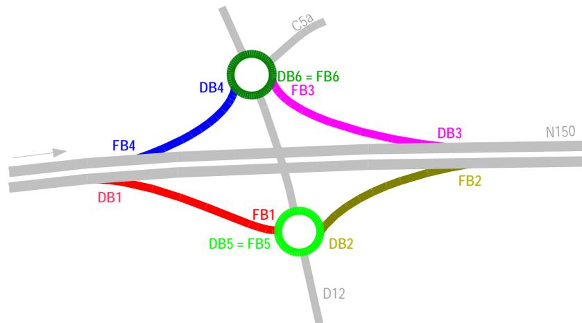
Illustration 44 : échangeur introduisant une discontinuité dans les axes desservis
