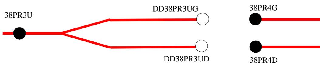
Exemple 2 : une discontinuité due à la prise en compte d'un giratoire en tant que dispositif d'échange après le PR 3 en chaussée unique
