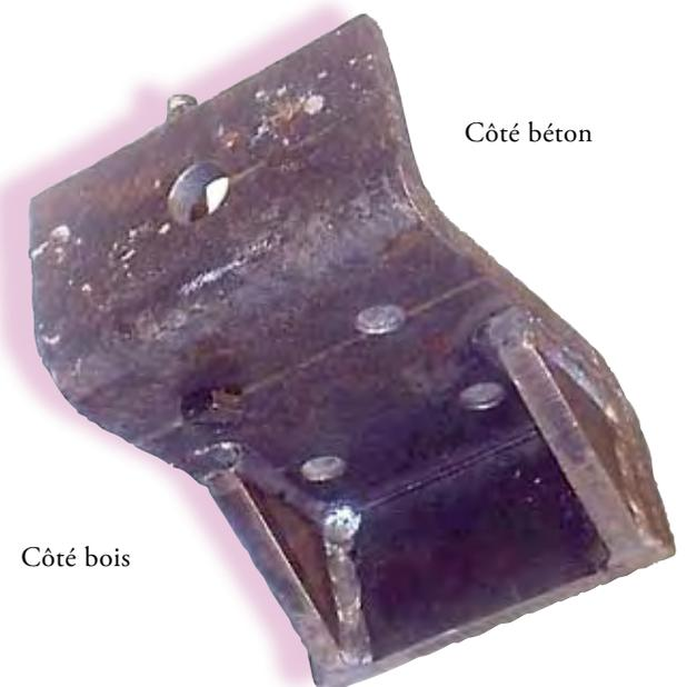
Photo 27 : exemple de connecteur bois-béton
