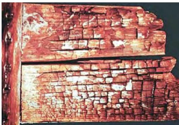
Photo 22 : exemple de pourriture cubique – Source : CNDB
