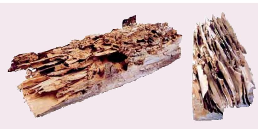
Photo 25 : dégâts dus à des termites – Source : CTBA
