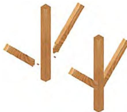
Figure 53 : assemblage par tenons et mortaises
