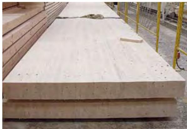
Photo 12 : poutre en lamellé collé d'épicéa – Source : Robert Leroy (Lcpc)
