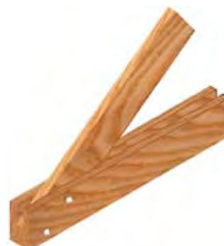
Figure 57 : assemblage boulonné
