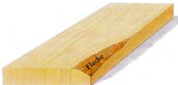
Figure 13 : schéma d'une flache
