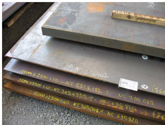
Traçabilité interne visible sur les tôles stockées (photo CETE SO)
