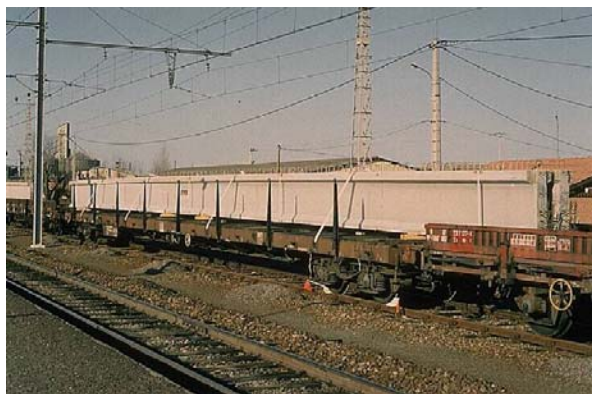
Transport d'éléments préfabriqués par voie ferrée (photo Sétra/CTOA)
