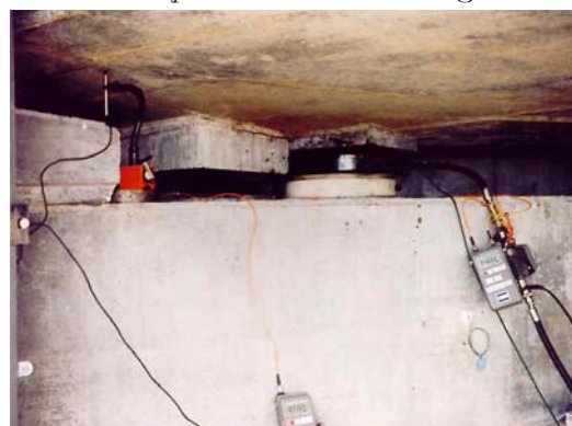
Pesée de réaction d'appuis (photo LRPC de Strasbourg)
