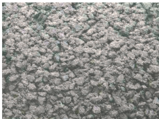
figure 4 : état de surface d'un BBDr micro-incrusté (source : CETE de l'Ouest)
