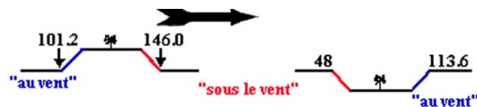
Figure 4 : influence de la direction du vent et du profil en travers sur les dépôts de plomb ( \mu\text{g}/\text{m}^2/\text{jour} ) Somme des valeurs à 5, 20 40, 80 m sur des parties en remblais et en déblais. A31 Sud – 42 000 Véhl/j – Février 98.
