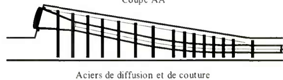
Fig. 2.28 - Bossages d'ancrage des câbles de continuité intérieurs
