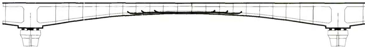
Fig. 3.10 - Câbles de continuité intérieurs en travée courante
