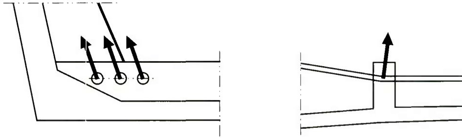
Fig. 4.11 - Efforts au droit d'un déviateur de précontrainte
