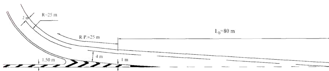
Fig. 16 — Schéma type d'une voie de décélération sur une route de type R à chaussées séparées.
