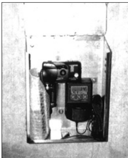
Photo n° 2 : Système Trail Master placé dans un boîtier métallique et comprenant un détecteur radar, un compteur électronique et un appareil photo autofocus avec flash intégré (temps d'installation : 2 h) - (COFIROUTE, OGE).
