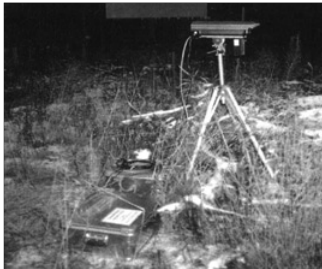
Photo n° 3 : Dispositif simple et compact facile à installer : le projecteur infrarouge est fixé sous la caméra posée sur un trépied. Au sol, dans les conteneurs étanches : la batterie, le magnétoscope (station ornithologique suisse du Sempach).
