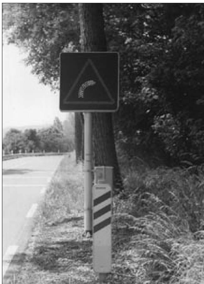
Caisson lumineux (D3-P.M.V.) présentant en alternance virage (A1) et présence du P.N. (A7)
