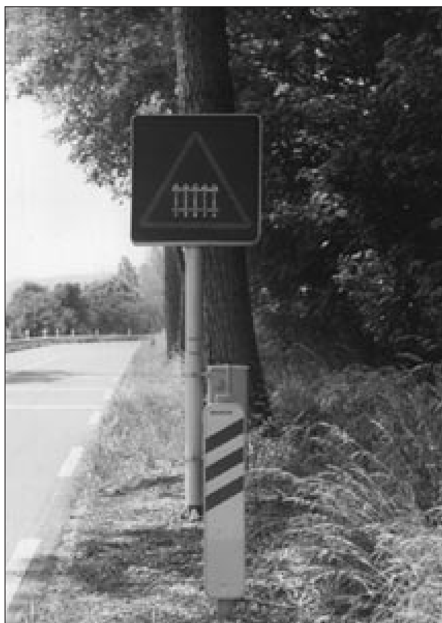
Caisson lumineux (D3-P.M.V.) présentant en alternance virage (A1) et présence du P.N. (A7)
