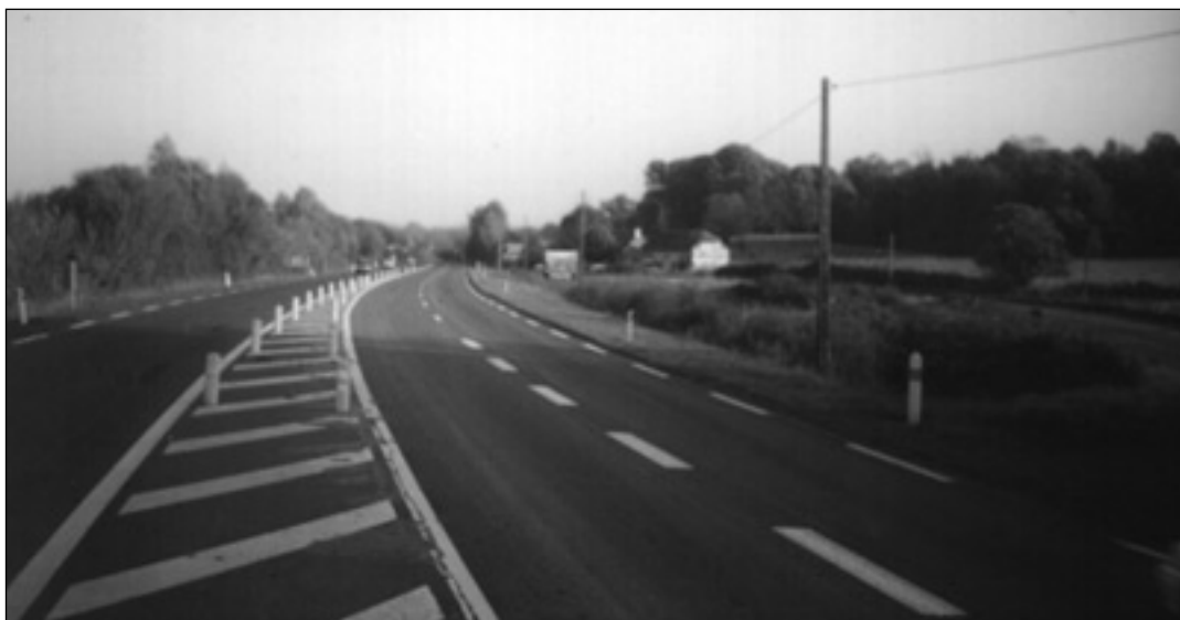
Photo 1 : Exemple d'implantation de balises souples J 11 en renforcement d'un marquage axial.
