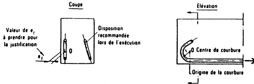
\*\* Il est indiqué que dans le cas de barres disposées en un seul lit, la condition de non-écrasement du béton est généralement satisfaite avec des rayons de courbure de  $3 \varnothing$  pour les ronds lisses en acier Fe E 215 ou Fe E 235 et de  $5,5 \varnothing$  pour les barres à haute adhérence en acier Fe E 400 ou Fe E 500.
