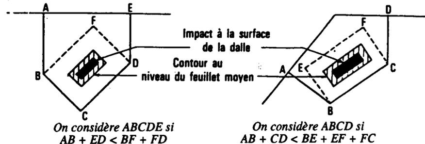
A.5.2,3. - Justification du béton avec armatures d'effort tranchant.
