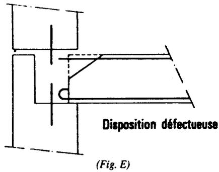
La liaison poteau-plancher doit être conçue également de façon à réaliser des conditions favorables de transmission des charges verticales (voir figure C). Il convient en particulier d'éviter des cheminements d'efforts faisant intervenir des éléments de natures ou d'âges différents, ou des parties fragiles\*.
