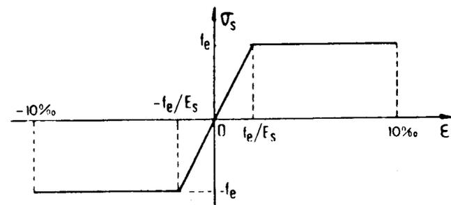
Il est cependant loisible d'utiliser une forme de courbe se rapprochant du diagramme réel de l'acier employé à condition de se référer à la valeur garantie de la limite d'élasticité  $f_e$  et de contrôler la résistance prise en compte pour l'allongement de 10 ‰ \*\*.
