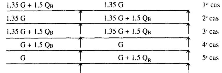
Le quatrième cas de charge est déterminant pour le calcul de la longueur des armatures en chapeaux du côté de la travée. Il doit être pris en considération pour la justification de l'équilibre statique, mais avec  $0,9 G$  dans la travée entre appuis (article B.3.3,1).
