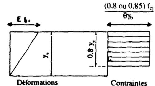
Sur une distance  $0,2 y_u$  à partir de l'axe neutre, la contrainte est nulle : sur la distance  $0,8 y_u$  restante, la contrainte vaut  $\frac{0,85 f_{cj}}{\theta \gamma_b}$  pour les zones comprimées dont la largeur est croissante (ou constante) vers les fibres les plus comprimées et  $\frac{0,8 f_{cj}}{\theta \gamma_b}$  pour les zones comprimées dont la largeur est décroissante vers ces mêmes fibres\*.
