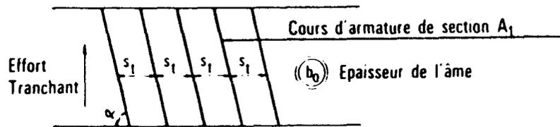
A.5.1,22. - Section minimale d'armatures d'âmes.
