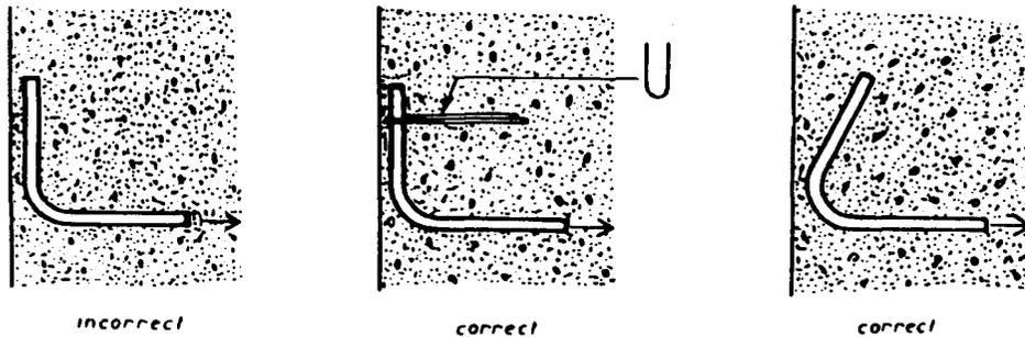
A.7.4.2. - Lorsque la poussée au vide d'une barre courbe est dirigée vers un parement, cette barre est attachée par des ligatures normales à elle, l'embrassant, et ancrées dans la masse du béton. Ces ligatures donnent lieu à vérification de résistance\* vis-à-vis de l'état limite ultime et sont fixées à la barre de façon qu'elles ne puissent se déplacer par rapport à elle lors de la mise en oeuvre du béton\*\*.
