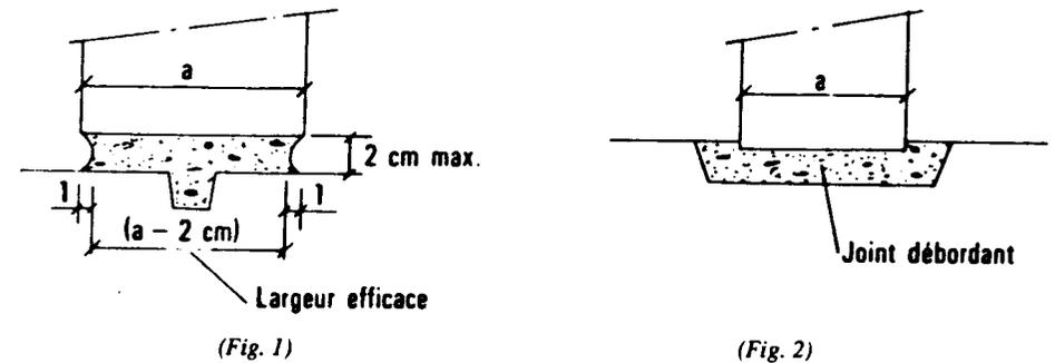
Compte tenu des coefficients minorateurs des résistances des matériaux (béton ou mortier) la contrainte de compression ultime est fixée à  $0,4 f_{c28}$ .
