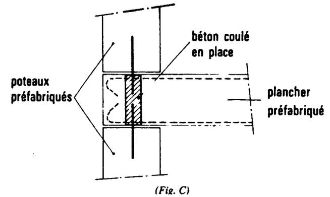
La liaison poteau-plancher doit être conçue également de telle sorte que les aciers de chaînage prévus dans le plancher s'opposent à tout déplacement horizontal de la tête du poteau inférieur ou du pied du poteau supérieur\*\*.
