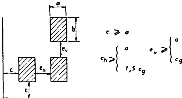
A.7.2.3. - Les armatures peuvent être groupées en paquets à condition de les disposer de façon compacte et d'opposer le minimum de gêne à la mise en place du béton. Dans tous les cas, la hauteur du paquet doit être au plus égale au double de sa largeur\*.
