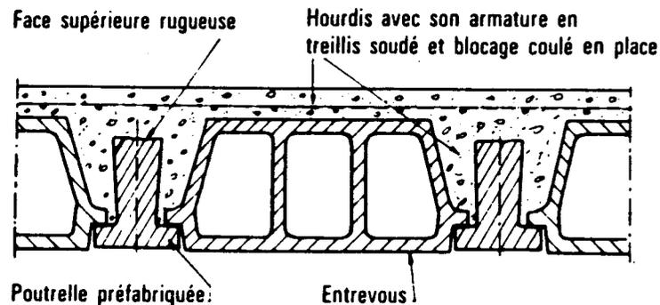
*\*\* Lorsque les entrevous sont plus hauts que les poutrelles, la forme des entrevous doit permettre un bétonnage aisé du blocage, ce qui nécessite un évasement de la section du béton coulé d'autant plus grand que la différence de hauteur est plus grande.*
