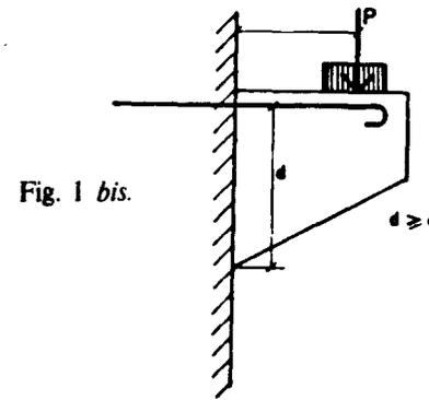
\* En particulier pour une charge répartie uniformément sur une longueur  $\ell = 2 a$  à partir de la section d'encastrement, la console est considérée comme « console courte » si  $d > \ell$  ou  $d > 2 a$  (fig. 2 et 2 bis).
