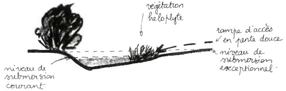
fig. 12 : Bassin à pente variable, la partie en pente douce permet d'accéder facilement au bassin.
