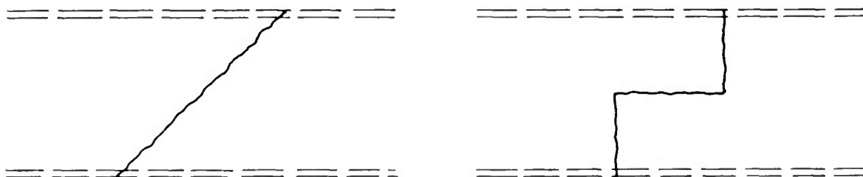
Dalles biaisées - Formes de reprises à éviter (vue en plan)
