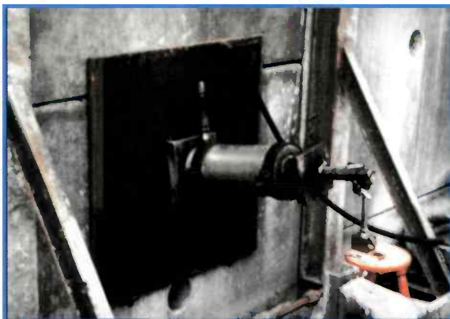
Figure B47 : Essai préalable de traction sur un clou
