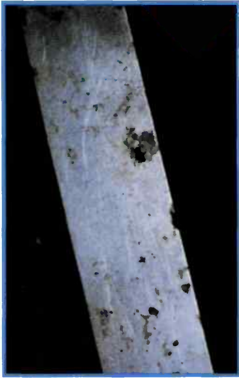
Figure A1 : Corrosion d'armatures en acier inoxydable
