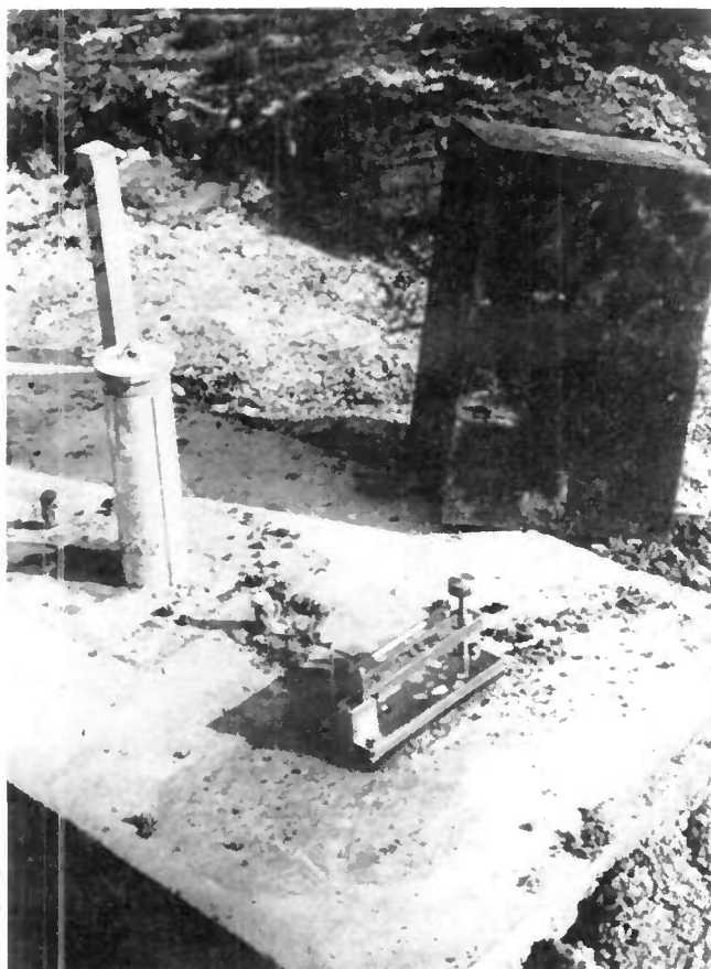
Fig. 18 — Plot pour la surveillance des mouvements profonds et de surface, équipé d'un capot de protection.
