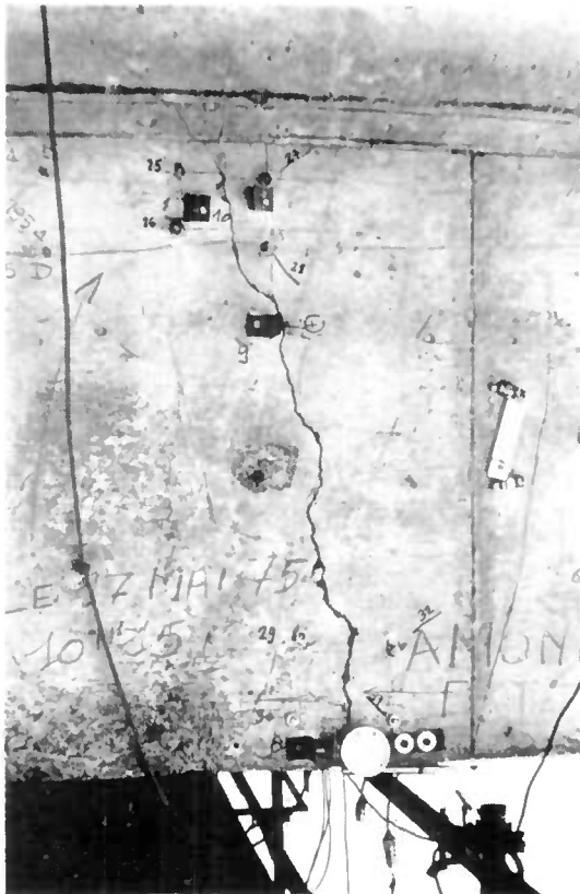
Fig. 11 — Variation brutale de l'excentricité de la précontrainte...
